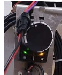
3) Grøn og Gul diode bekræfter Servicetilstand
