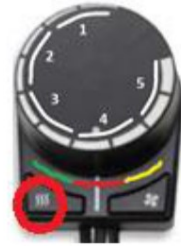
3 & 4) Drücken Sie die Heat-Taste, um den Pumpenmodus umzuschalten
