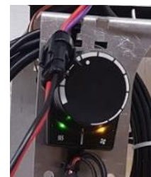
3) Grüne und gelbe Lichter zeigen an, dass der Servicemodus eingeschaltet ist
