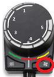
2) Drücken Sie die Lüftertaste innerhalb von 5 Sekunden
