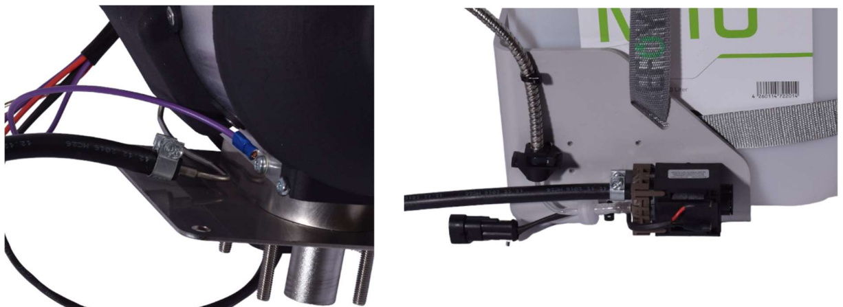
Figur 8 sikring af brændstofslange med spændebånd
