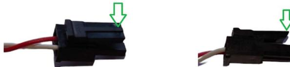
**Schneiden Sie das weiße Kabel direkt hinter dem Stecker ab und verbinden Sie das weiße Kabel mit dem Ausgang des Schalters. Verbinden Sie das andere Bein des Schalters mit 12V+**
