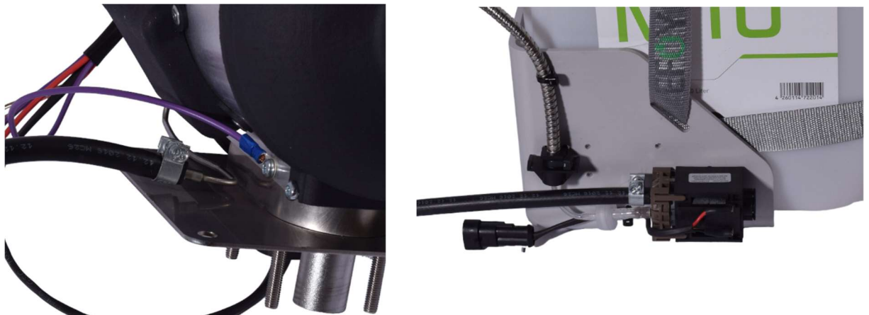
Figur 8 sikring af brændstofslange med spændebånd
